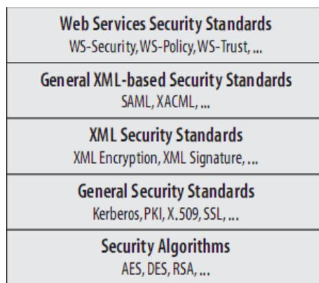
Figura 14 - Pilha de tecnologias de Segurança em XML e *Web Services*
