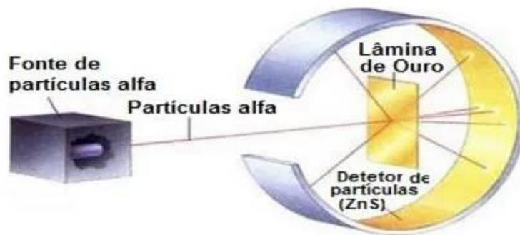
**Figura 8:** Esquema do experimento de Rutherford.
