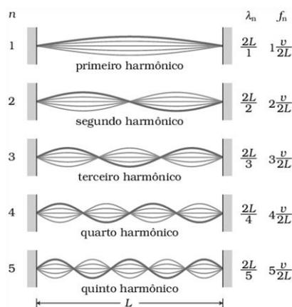
Figura 1. Ilustração de ondas estacionárias em uma corda
