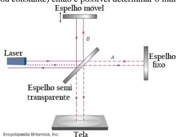
Desta forma, o interferômetro de *Michelson* (assim como qualquer interferômetro) pode ser usado para determinar: variações do caminho geométrico (e óptico), bem como o índice de refração do meio de propagação da radiação.
