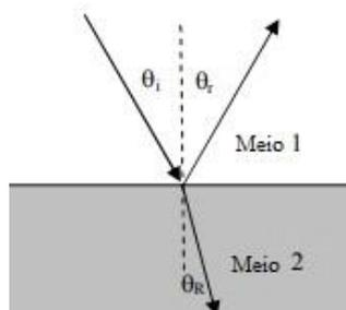
Figura 2: reflexão e refração de um raio luminoso ao propaga-se em meios distintos com  $n_2 > n_1$
