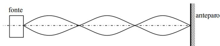
Figura 1. Onda estacionária em uma corda com três ventres e 4 nós.
