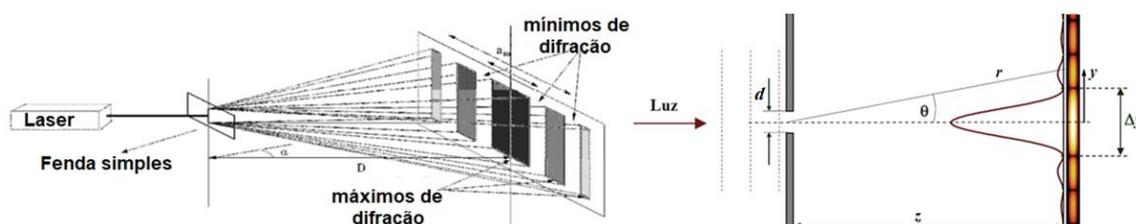
Figura 1. Ilustração de resultado de difração em uma fenda simples e ao lado uma representação geométrica.
