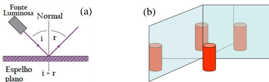
Figura 4: Representação da reflexão (a) em um espelho plano e (b) dois espelhos planos com um ângulo de aproximadamente 90°.
