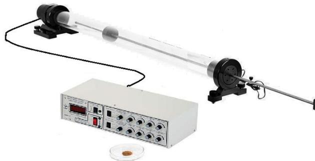
Figura 1. Ilustração de um aparato similar ao do experimental do tubo de Kundt
