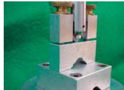
Fig. 3 - Cisalhamento do corpo de prova.
