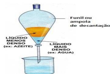
Figura 10. Separação água e azeite. (Fonte: [www.cocasmachado64.blogspot.com](http://www.cocasmachado64.blogspot.com))
