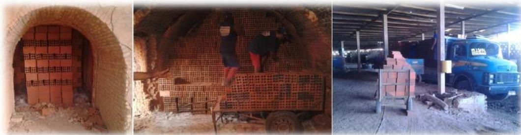
Retirada dos blocos de cerâmica vermelha após o cozimento e resfriamento do forno para sua comercialização, Itabaiana (SE), 2015.
