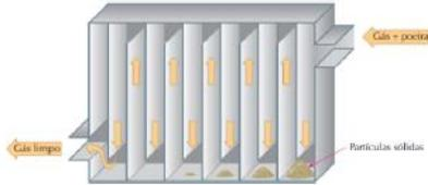
**Câmara de poeira:** separação entre sólido-gás. É uma separação com uso de uma câmara com subdivisões nas quais a mistura de sólido e gás bate, deixando o sólido retido e permitindo a saída do gás. Por exemplo: separação de fuligem do ar.
