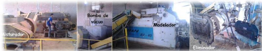
Misturador, bomba de vácuo (extração do excesso de água), modelador e eliminador da Cerâmica Serrana, Itabaiana (SE), 2015.
