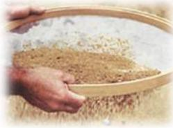
**Peneiração:** separação entre sólido-sólido. É processo usado para separar sólidos de diferentes tamanhos, geralmente passando por uma peneira, sendo que os sólidos menores passam por sua malha, sendo separados dos maiores. Por exemplo: na separação de pedras da areia.
