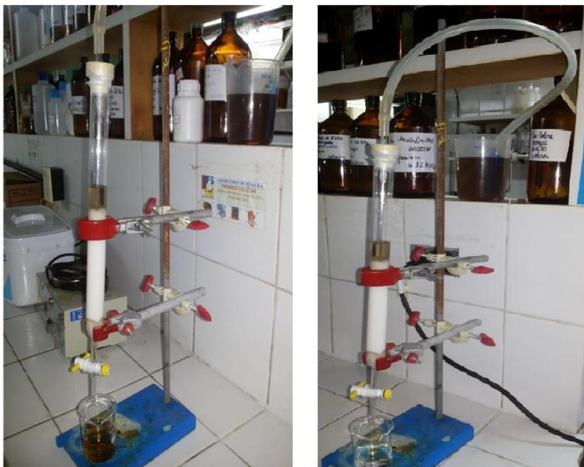
**Imagem 1:** Coluna 1 e coluna 2 do experimento de purificação da água utilizando a resina de troca iônica.
