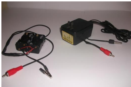
Figura 34: Fontes de energia do dispositivo de condutividade elétrica de sólidos. Fonte: Elaborada pelo próprio autor.
