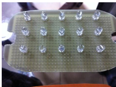
Figura 23: Imagem dos LEDs conectados na placa Fenolite. Fonte 17 : Blog spot.
