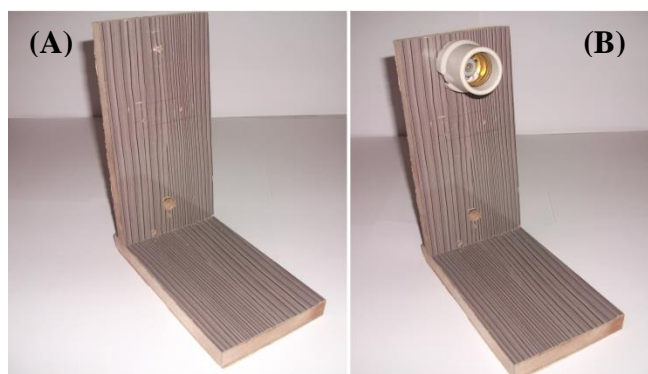
Figura 30: (A) Compensados na forma de L. (B) Bocal da lâmpada fixado no suporte. Fonte: Elaborada pelo próprio autor.
