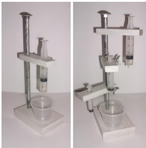
Figura 41: Suporte concluído para titulação. Fonte: Elaborada pelo próprio autor.
