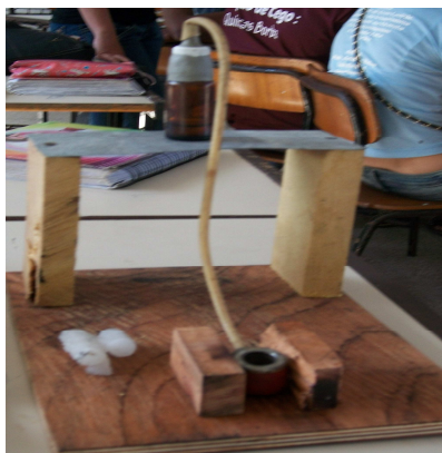
Figura II: Máquina Térmica para demonstração por Costa, L. M, 2012 adaptada de Damélio, S. 2006.
