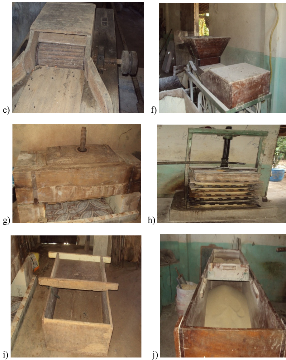
Figura 02. Fotografias representando a estrutura e materiais de uma casa de farinha: a) Forno de barro, b) Forno industrial, c) Rodete antigo, d) Boca do forno, e) Bola do rodete antigo, f) Rodete industrial, g) Prensa antiga, h) Prensa industrial i) Peneira antiga j) Peneira industrial l) Balança m) Plantação n) Sacos de farinha o) Raspas.
