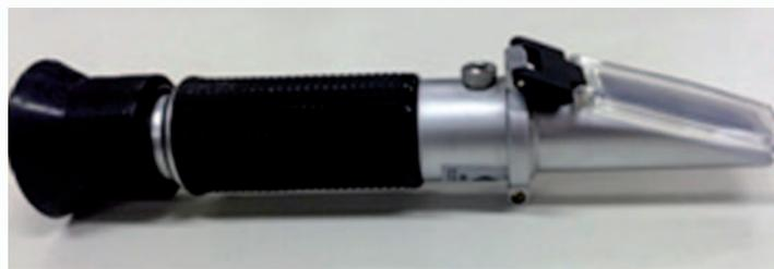
Figura 3: Refratômetro
