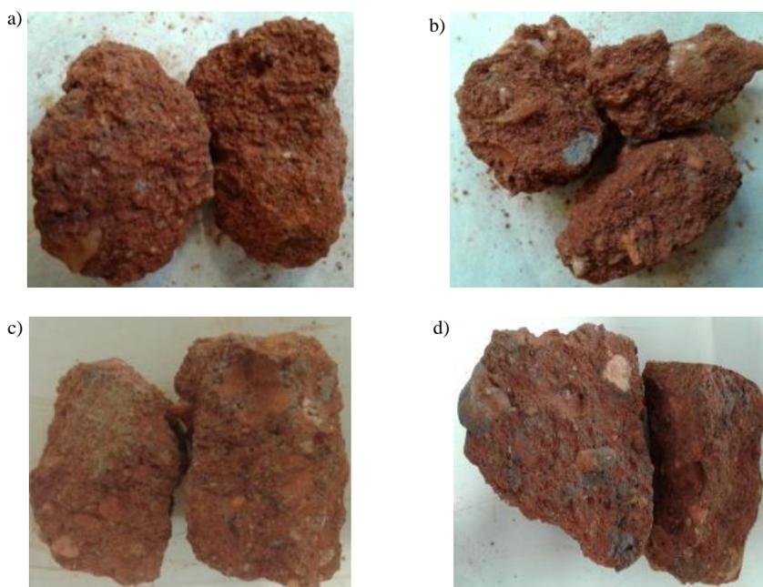
**Figura 1.** Torrões da mistura de solo e 3% (a), 5% (b), 7% (c) e 9% de cimento (d), após o ensaio de rompimento à compressão aos sete dias de cura.
